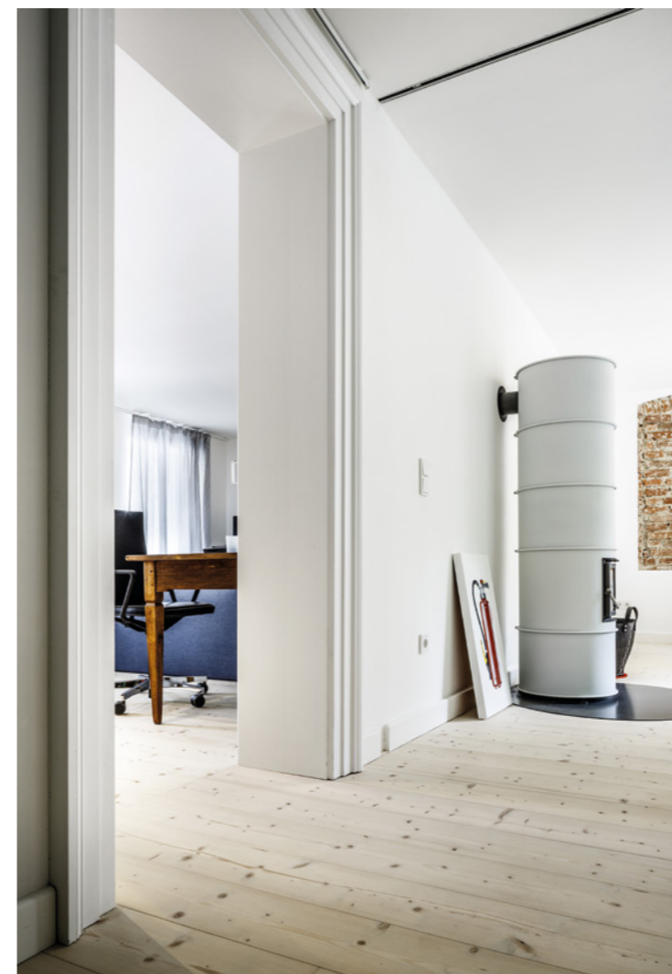
Der Speicherofen erzeugt mit relativ wenig Holz Strahlungswärme für mehrere Stunden.
